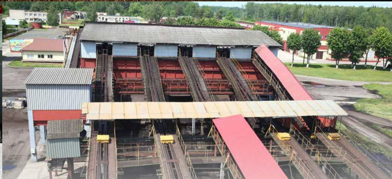
После подготовительного отделения сырье поступает в сушилки «Цемаг». Высушенный торф распределяется по прессам, в которых непосредственно и происходит брикетирование. Топливные брикеты по охлаждающим лоткам поступают на склад готовой продукции.
