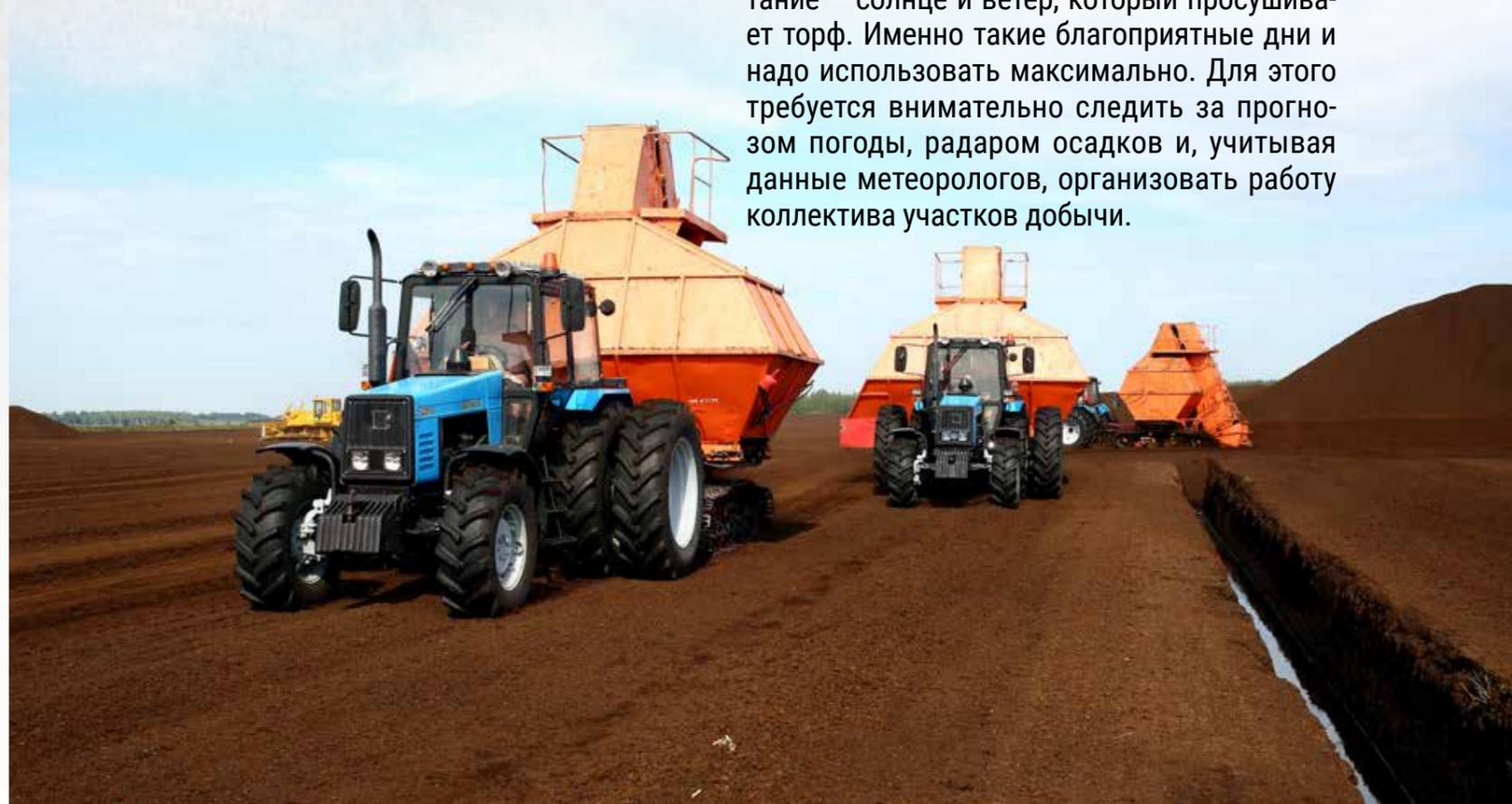
Не менее важный этап – подготовка болот. Отведенные земли очищают от растительности, выкорчевывают пни, создается сеть осушительных каналов. Для работы станции водопонижения подводится высоковольтная линия электропередачи. Квадраты земли, отделенные друг от друга каналами, называются картами. Поверхность каждой карты должна быть выпуклой в центре, чтобы вода уходила в каналы.
